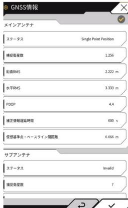
「メインアンテナ」の「鉛直 RMS」と「水平 RMS」が 0.02 以下であることを確認します。0.02 以下でない場合は、衛星の受信状態が良好になるのを待ってから再度確認してください。
